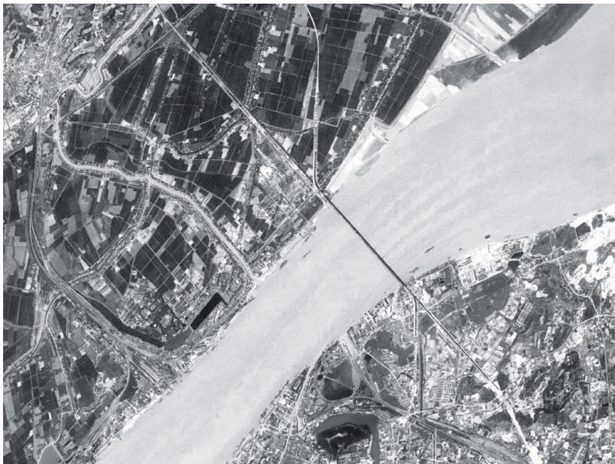
图5 KH-4 卫星于 1967 年 8 月拍摄的已经开始铺设桥面的南京长江大桥。长江两侧的铁路引桥仍在施工中，公路引桥则刚刚开始建造
