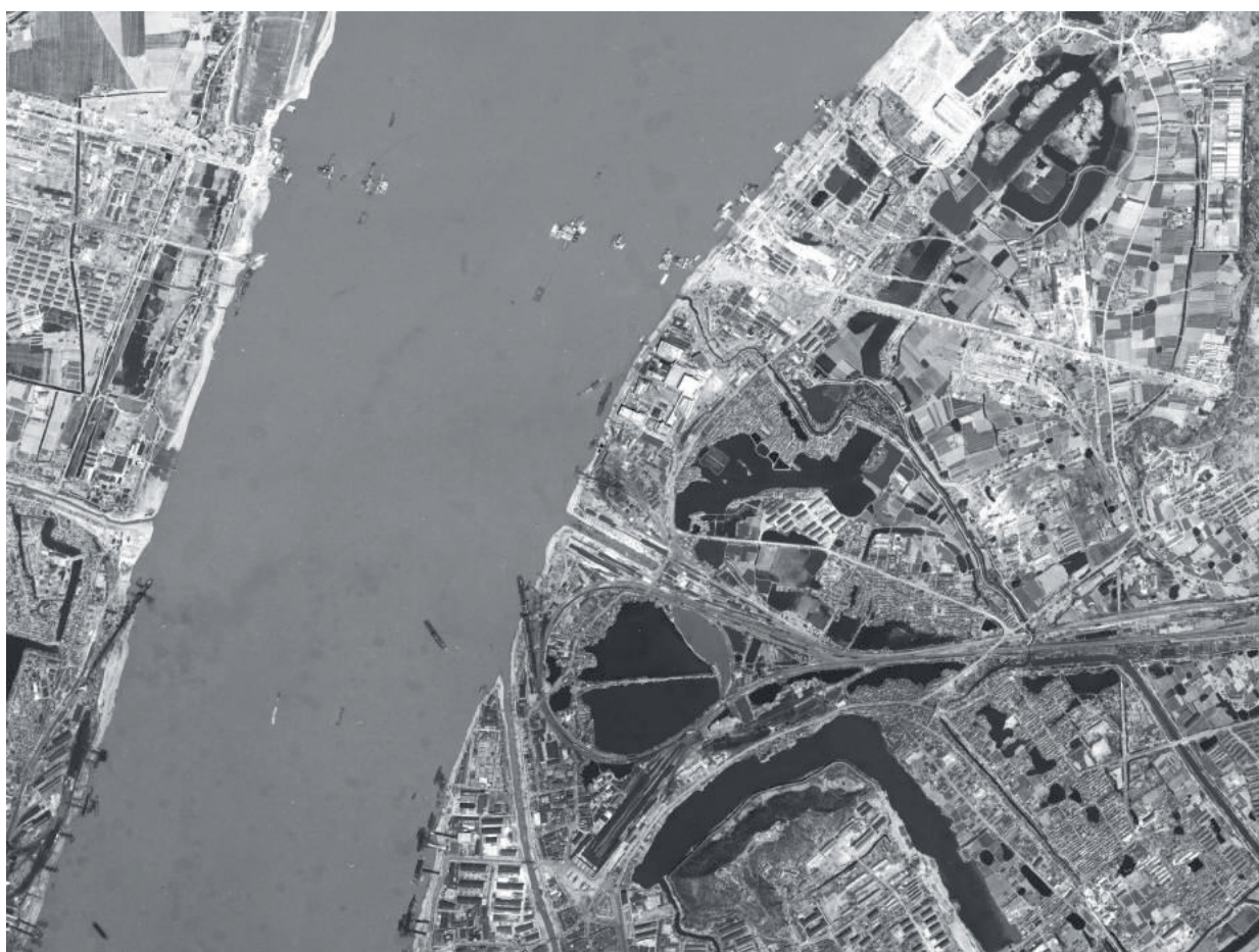
图4 U-2侦察机于1962年3月拍摄的建设中的南京长江大桥。长江中可见施工中的桥墩，两侧铁路引桥也已经开始打桥墩，公路引桥还没有动工。值得注意的是下方津浦铁路浦口站与沪宁铁路下关站之间正在运营的火车轮渡
