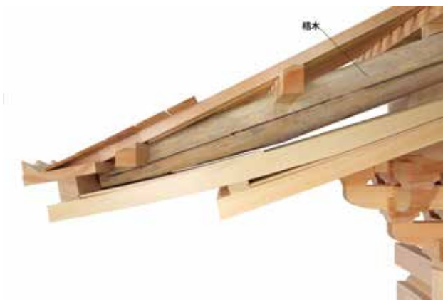
图4 奈良药师寺东院堂 1:2 模型屋架中的桷木, 竹中大工道具馆收藏
