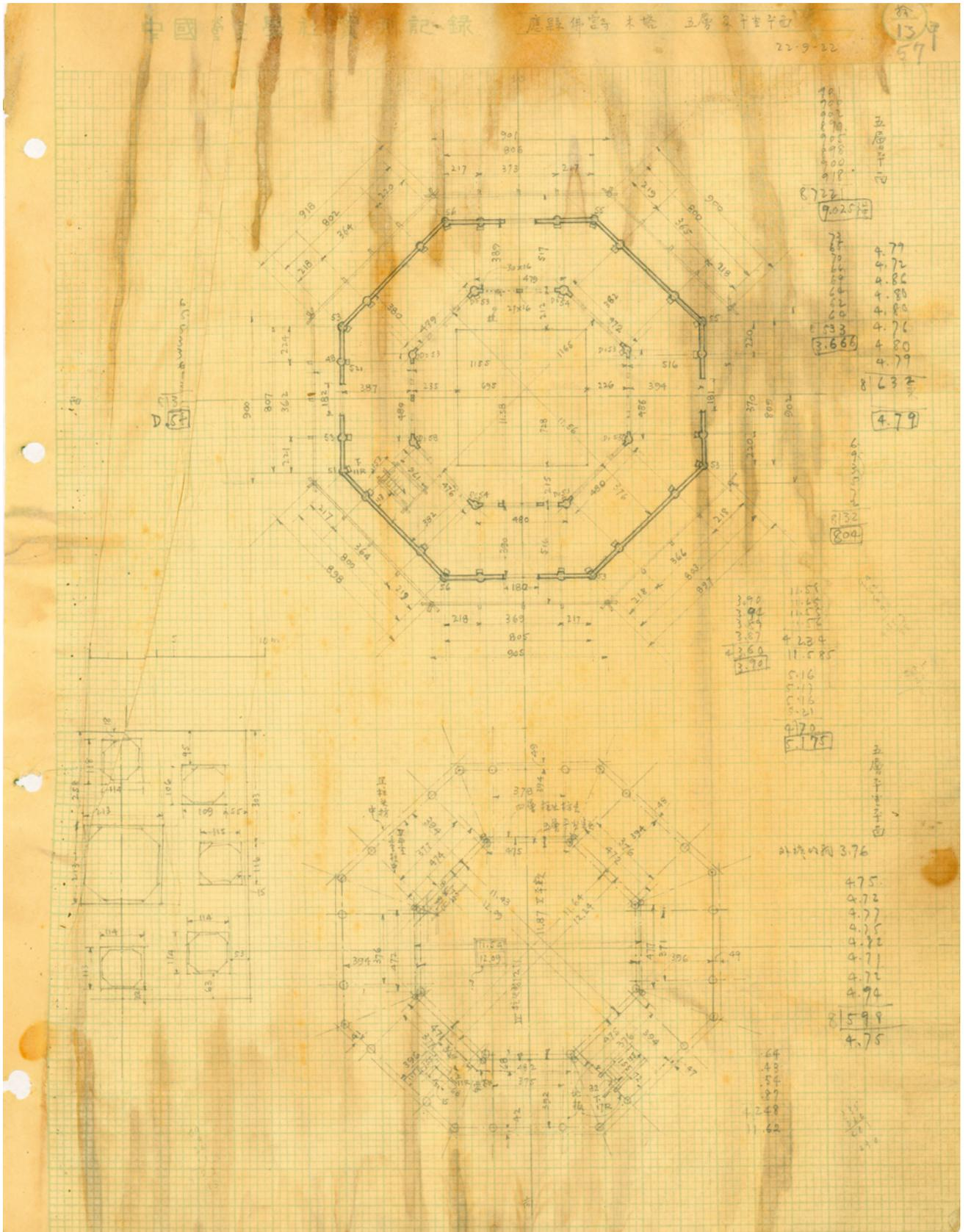
山西应县佛宫寺释迦塔五层平面图及测稿
